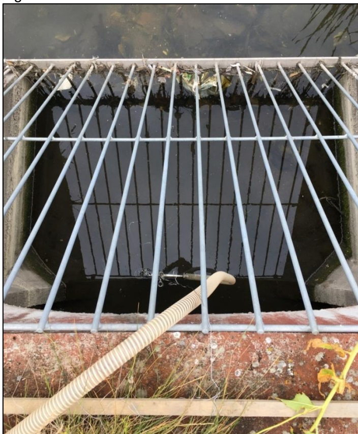
Figur 6. Provtagning för inkommande flöde i fördiket. Filterhållaren är fastmonterad med ståltråd i trästaven och kopplad till inloppssuget. Foto: Yvonne Trinh
