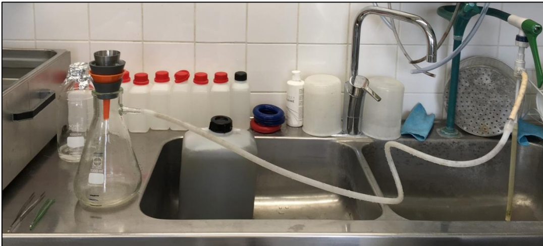
Figur 3. Mätuppställning bestående av olika delar för filtrering. Foto: Yvonne Trinh.
