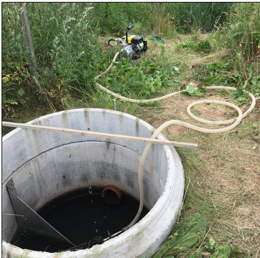
Figur 7. Provtagning för utgående flöde i provtagningsbrunnen. Filterhållaren är fastmonterad med ståltråd i trästaven och kopplad till inloppssuget. Motorn och utloppsslangen ses även i figuren. Foto: Yvonne Trinh.
