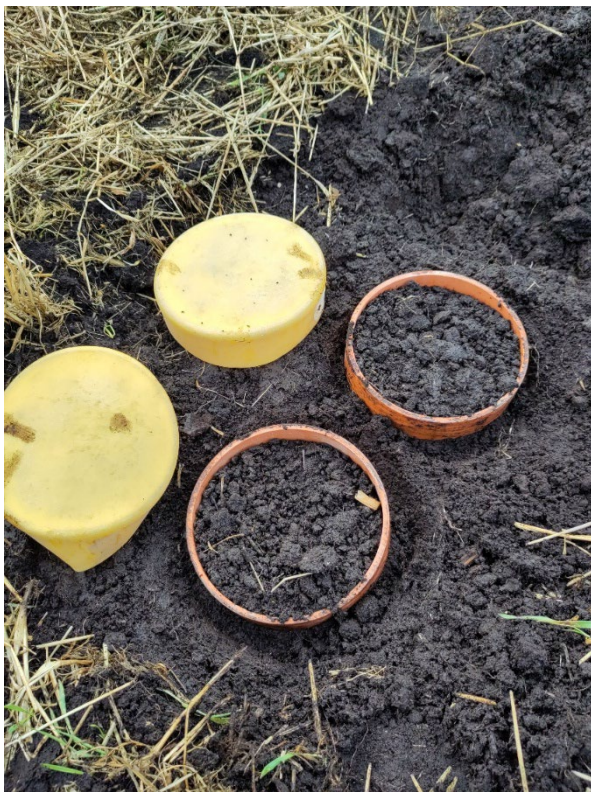
Figur 1. Smålysimetrar med kärrtorv uttagna i Broddbo.
