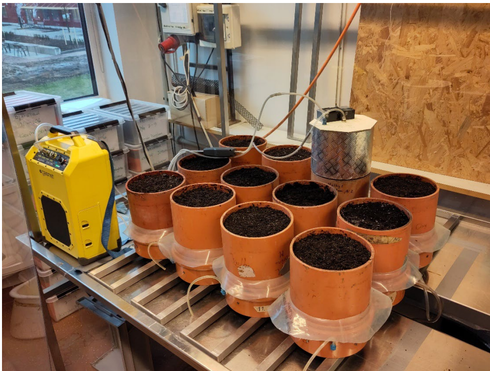
Figur 3. Analys av växthusgasavgång med Gasmeter GT-5000 terra före regnsimulering genom att cirkulera luften ovanför lysimetern i kammaren genom sensorn.
