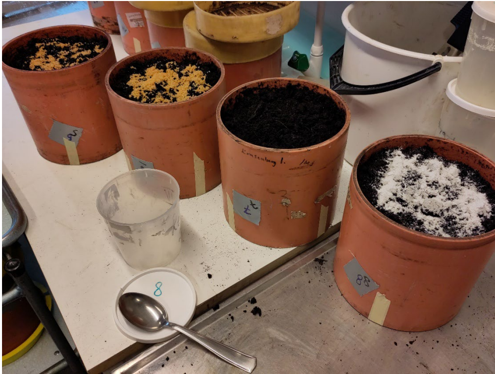
Figur 2. Inblandning av kalkpellets och kalkstensmjöl i ytan av proverna.
